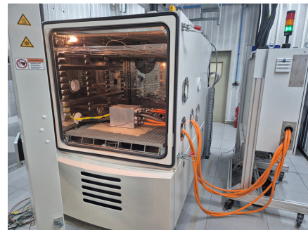
Onduleur IPEN SiC de forte puissance pour essais de caractérisation moteur avancés
