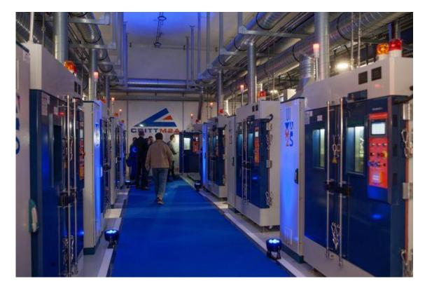
Enceintes climatiques dans lesquelles seront testées les cellules des batteries, au Giga test Centre du CRITT M2A. • © CRITT M2A
