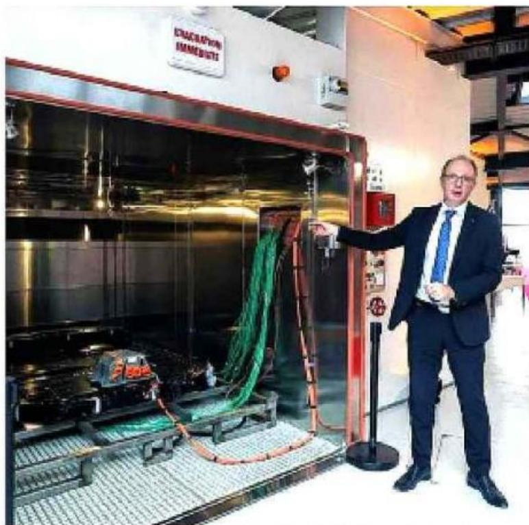
Jérôme Bodelle, président du CRITT M2A, présente un des six bancs d'essai qui vont permettre de tester les batteries électriques de nos futurs véhicules. PH. L. MAILLARD
