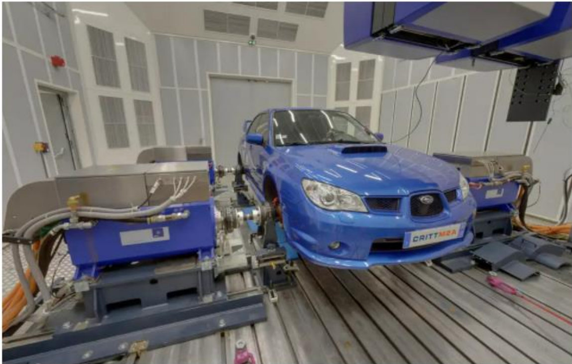
Le banc multi machines permettant de tester les véhicules, au CRITT M2A, à Bruay-La Buisnière. — CRITT M2A
