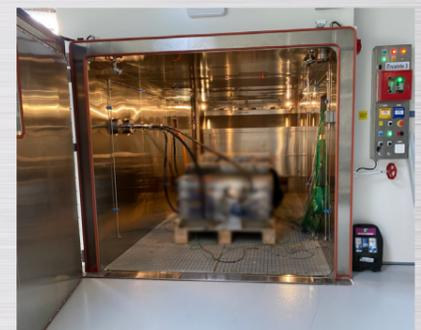
Le CRITT M2A a récemment mis en place des systèmes de refroidissement **liquide** encore plus efficaces sur tous les bancs de test de batteries.
