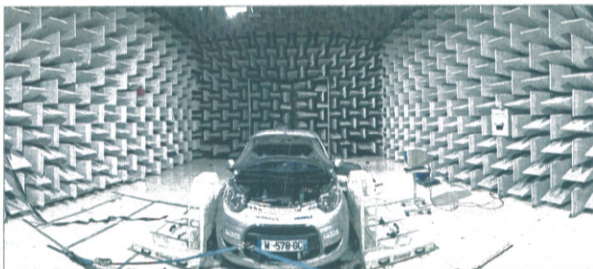
Dans les ateliers, il y a des capteurs de sons pour mesurer le bruit des moteurs.
