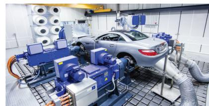
Equipé d'un logiciel de simulation de route, d'un robot pour simuler le conducteur et d'un système portable de mesure des émissions (PEMS), ce banc permettra d'accompagner les développements de plus en plus complexes.
