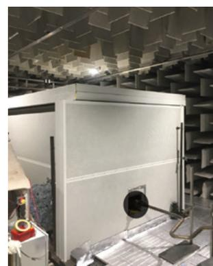
Cette installation permet de gérer et de réduire le bruit résiduel du GMP pour garantir une émergence de minimum 15 dB du bruit d'échappement (intervalle de bruit de fond typique), par rapport à ce bruit résiduel.
