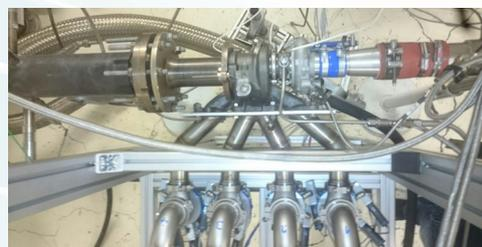
L'objectif de ce type d'essai est de tester le turbocompresseur dans un environnement plus représentatif qu'avec un banc traditionnel, grâce à l'utilisation d'un banc et d'une instrumentation spécifique.
