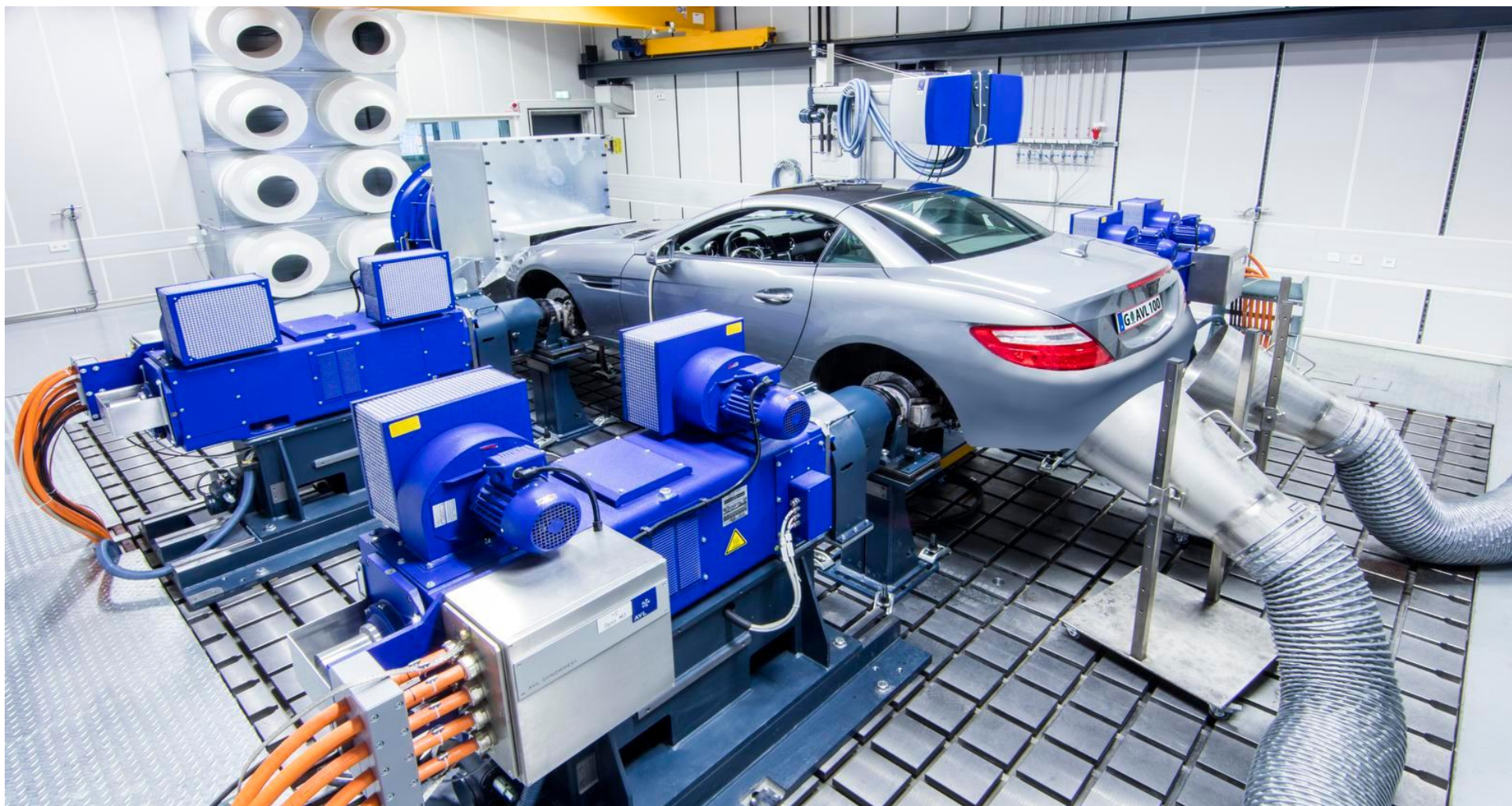
Le CRITT M2A va se doter de six moyens d'essai pour les batteries et d'un banc multimachines (ci-dessus) capable de tester un véhicule entier, qu'il soit thermique, hybride ou électrique. PHOTO PETER RIEDLER
