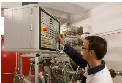
Étalonnage d'un banc d'essais turbos
